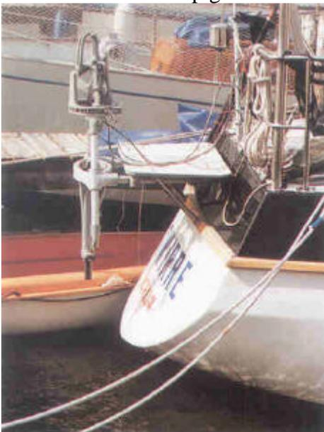
I sistemi a servo-pendolo con un braccio a pendolo verticale hanno a volte bisogno di supporti speciali per specchi di poppa inclinati in avanti.
