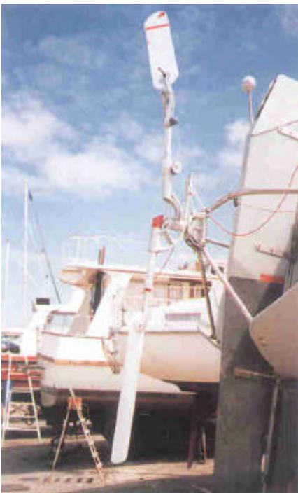
Il timone a pendolo genera le servo-forze con la sua escursione laterale. Queste forze sono trasmesse al timone principale. La quantità di forza viene determinata dalla lunghezza del braccio a pendolo dal suo fulcro sino alla punta inferiore della pala del timone. Questa distanza, detta leva di forza (power leverage, PL) è generalmente compresa tra i 150 e i 200 cm. Il timone a pendolo ha una superficie di circa  $0,1 \text{ m}^2$ .
