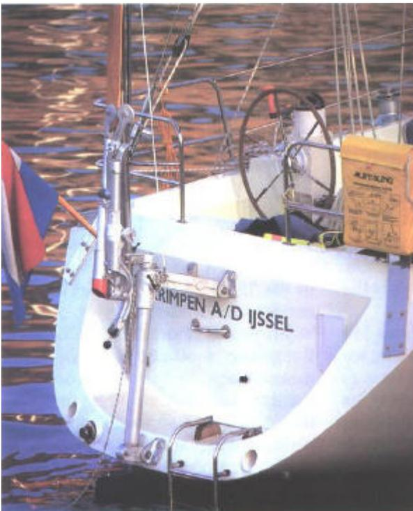
Sugar scoop di un Taswell 48 con un sistema Windpilot Pacific Plus con il braccio a pendolo in posizione di riposo.
