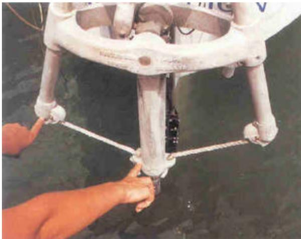
Un buon sistema a servo-pendolo può generare una forza di governo che può arrivare sino ai 150 kg: abbastanza per mantenere felicemente la rotta di qualunque barca sino ai 60 piedi. La chiave di una buona performance di governo effettiva di un sistema a servo-pendolo è, semplicemente, la qualità della trasmissione della forza.
