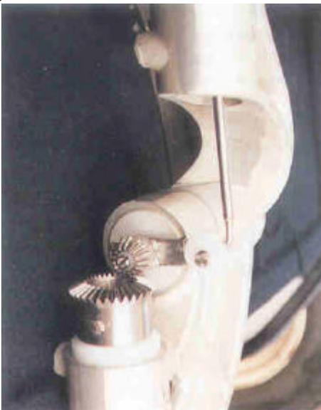
Ingranaggio a ruote coniche con rapporto di 2:1 del Windpilot Pacific.
