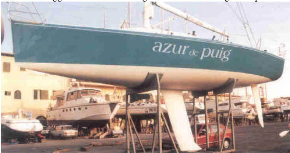
Le linee dello scafo di una barca moderna con timone compensato: veloce, ma non particolarmente confortevole
