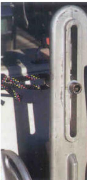
Il Windpilot Pacific (modello 1998) ha un dispositivo di trasmissione della forza regolabile.
