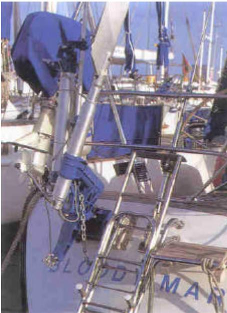
Un sistema a servo-pendolo montato lateralmente non funzionerà in maniera efficace
