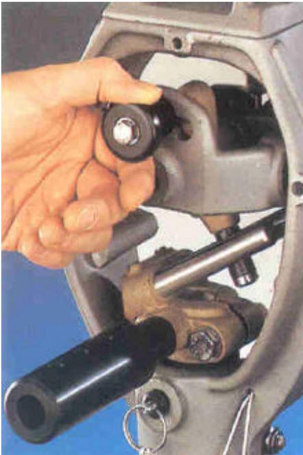
Per un migliore smorzamento, il giunto di trasmissione del Hydrovane è dotato di un demoltiplicatore
