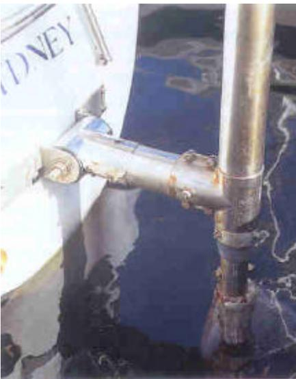
Il sistema BWS-Taurus sarebbe migliore se dotato inferiormente di un supporto a V
